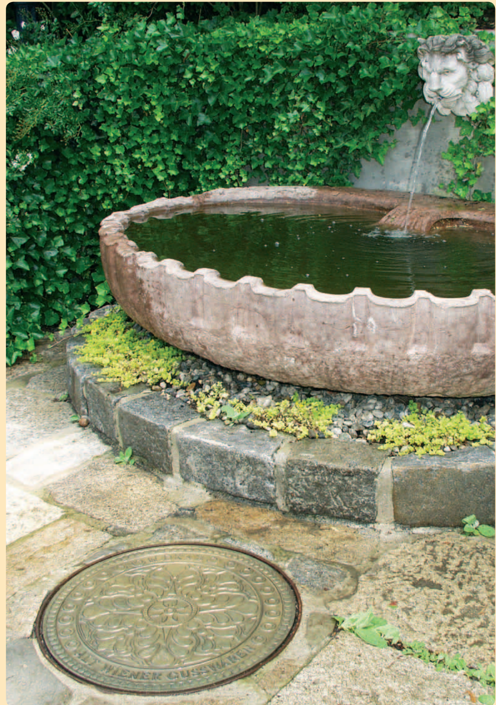
Schachtabdeckung mit Einbauring Art. 19615 *: Deckel ø 500 mm, Ring ø 590 mm, H: 80 mm, Deckel 26 kg, Ring 36 kg: Bronzeguss Art. 19620 *: Deckel ø 600 mm, Ring ø 720 mm, H: 130 mm, Deckel 85 kg, Ring 60 kg Sichtseite Bronzeguss, Unterseite Grauguss Art. 19616 *: Deckel ø 500 mm, Rahmen 675 x 675 mm, H: 90 mm, Deckel 26 kg, Rahmen 60 kg, Deckel und Rahmen aus Bronzeguss, begehbar und Pkw befahrbar, ohne Prüfzeichen
